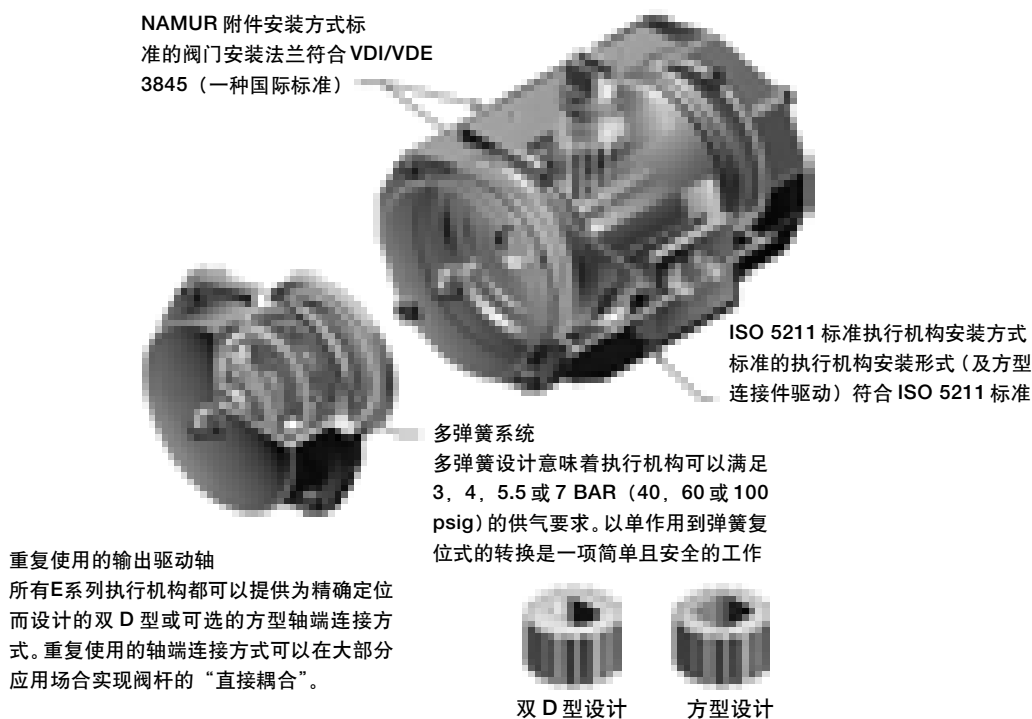
图 2. 执行机构的结构
